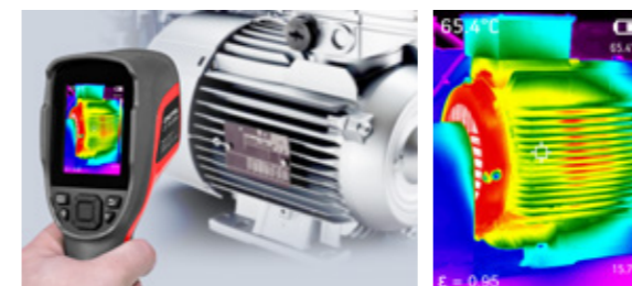
ОЦЕНКА СОСТОЯНИЯ ИЗОЛЯЦИИ
